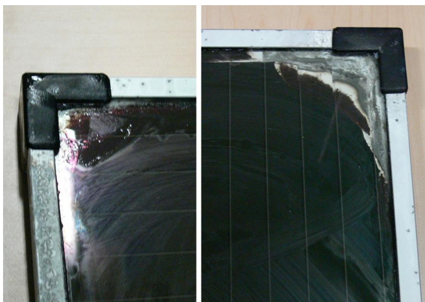
Obr. 4.24: Vzniknutá elektrochemická korózia (detail).
