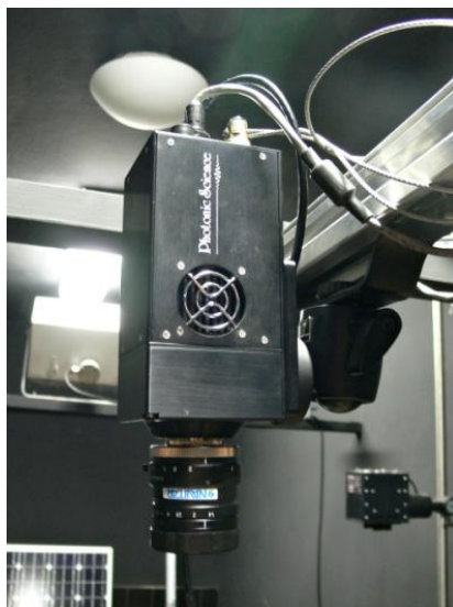
Obr. 4.6: Gárium Arzenidová kamera použitá k meraniu metódou elektroluminiscencie.
