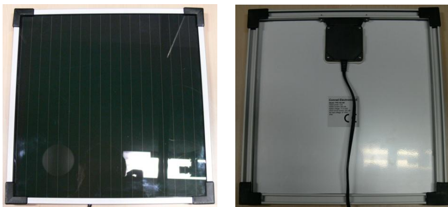
Obr. 4.1: Fotovoltaický modul Conrad TPS-103 4W odfotený z prednej a zadnej strany.
