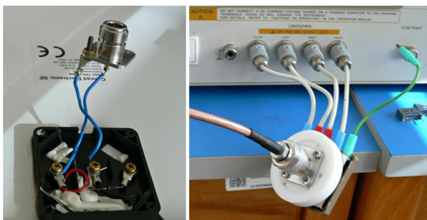
Obr. 4.12: Ukážka spôsobu zapojenie vodičov na strane modulu (vľavo) a na strane meracieho zariadenia (vpravo).
