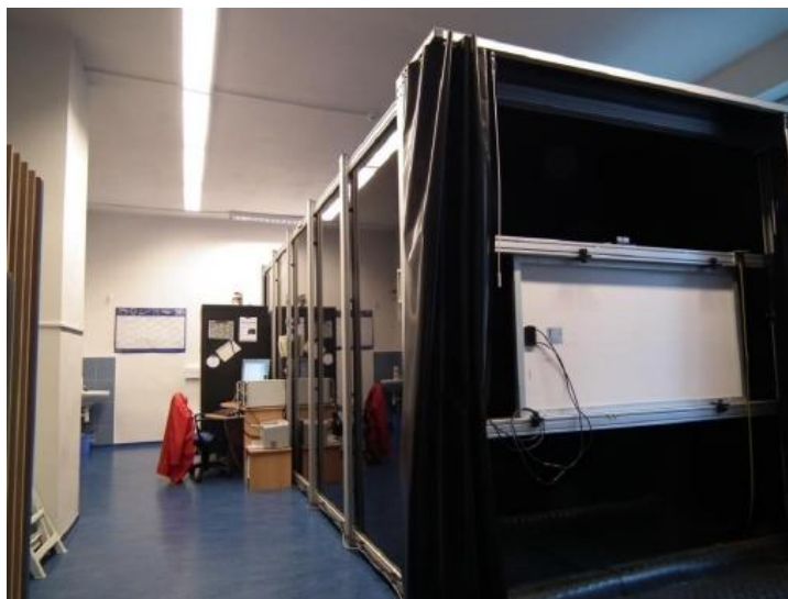
Obr. 4.3: Ukážka pracoviska flash testu.
