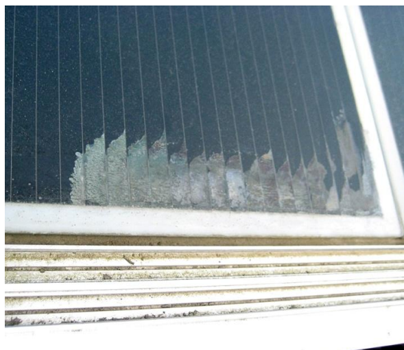
Obr. 2.7: Tenkovrstvý solárny modul s nevratným PID. [16]
